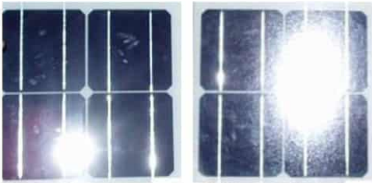
Bild 3.2.3: Diffuse Reflexion von unterschiedlichen Moduloberflächen (Quelle: Sandia National Laboratories, Ausschnitt)
